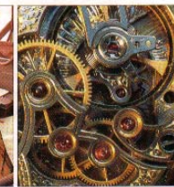
Rubinerna garanterar precision. I klockor är det viktigt att de lager som kuggkulan vilar i inte slits smeda. Rubinerna är så hårda att de slits mycket långsamt. Därför används de i klocklagren.
